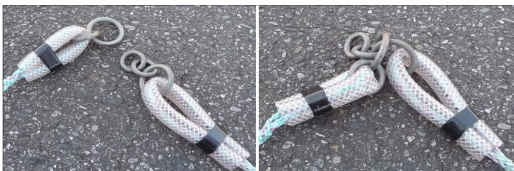
Rysunek 42. Zerwane elementy liny holowniczej. Źródło: [57].
