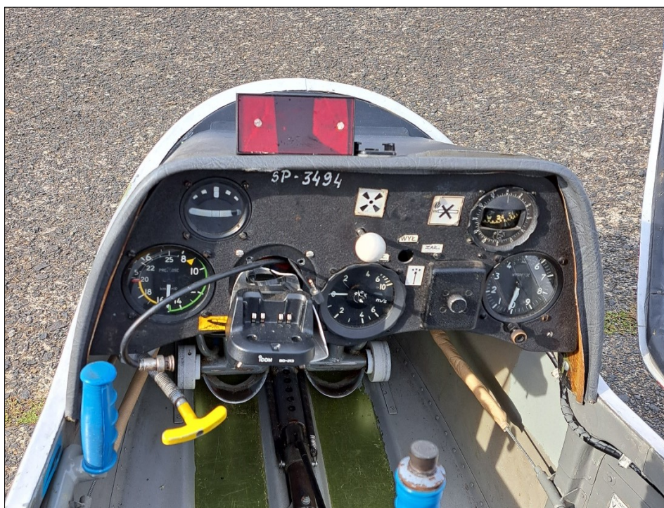
Rysunek 84. Wygląd zainstalowanego modułu systemu w kabinie szybowca. Źródło: materiały własne.
