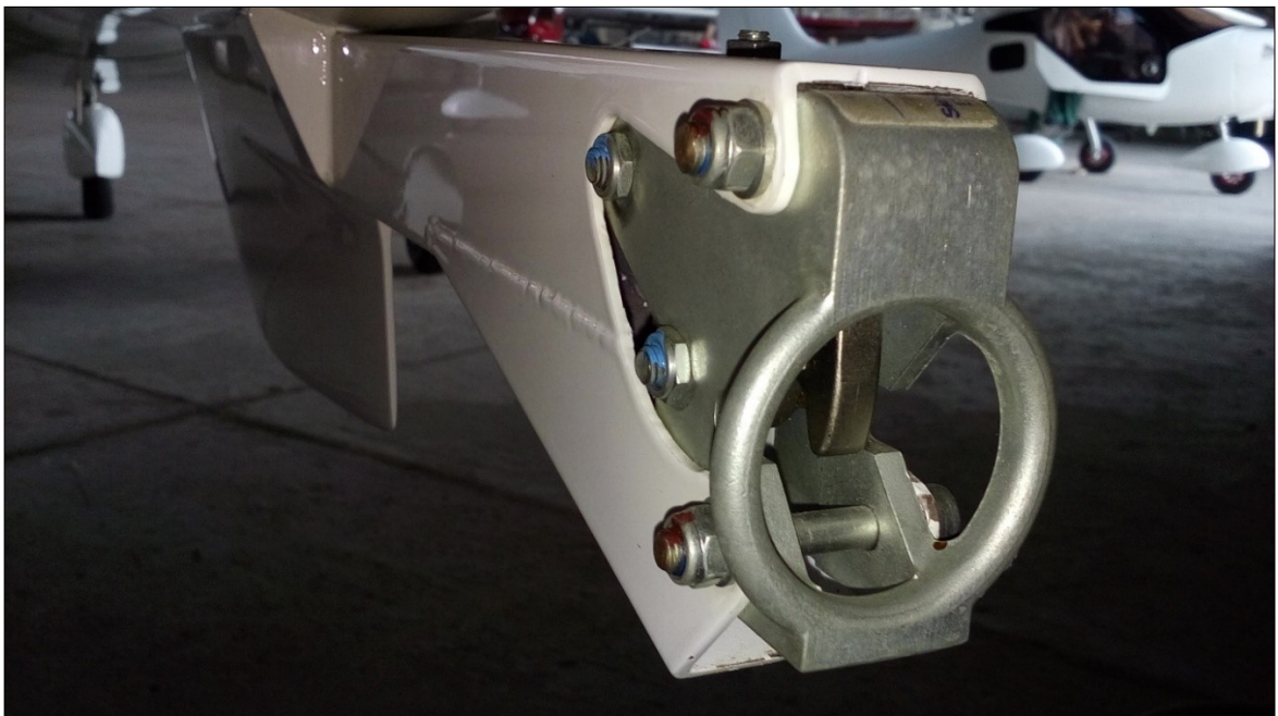
Rysunek 44. Zaczep holu w samolocie. Źródło: materiały własne.
