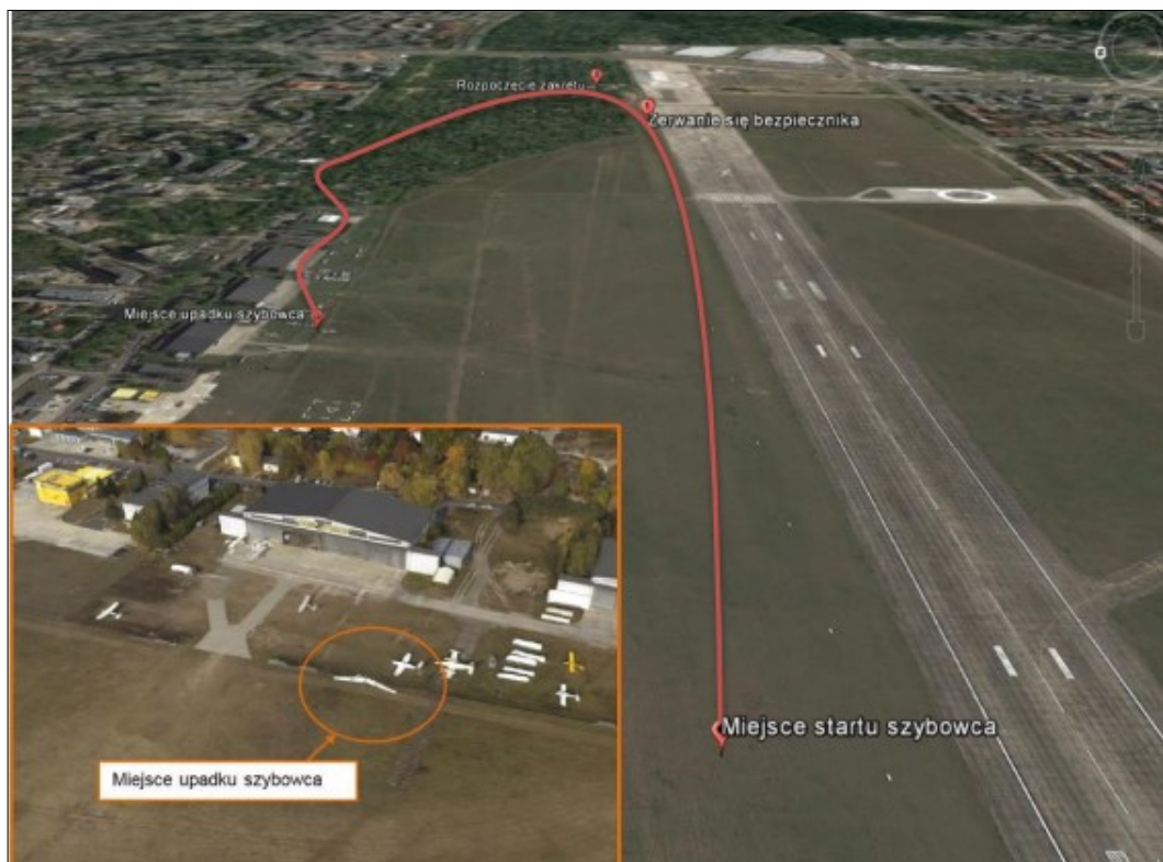
Rysunek 36. Przybliżona trajektoria lotu szybowca Puchacz, SP-3782 z dnia wypadku 30.08.2017.
