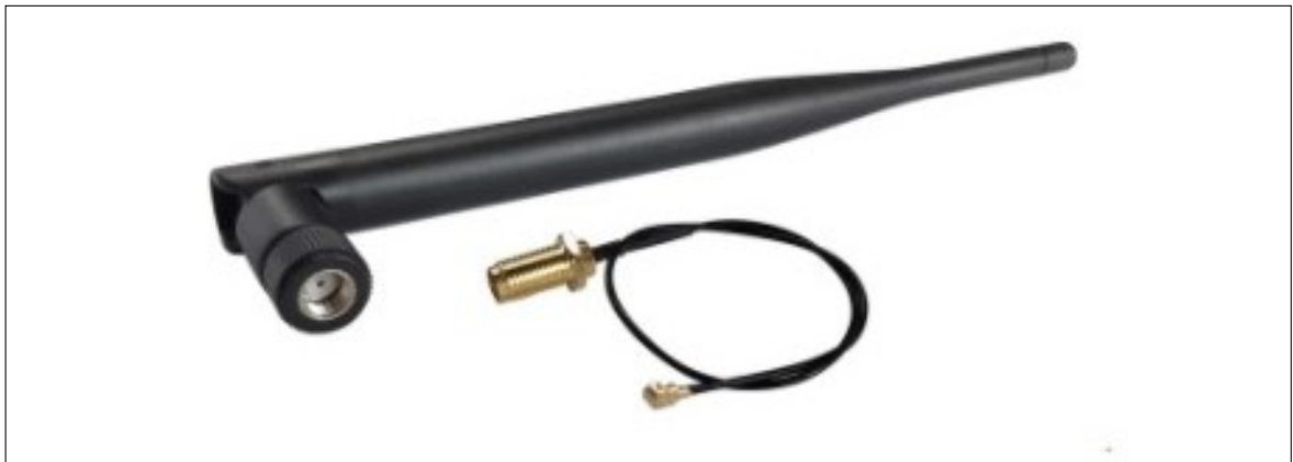
Rysunek 68. Antena dookólna 5 dBi. Źródło: materiały własne.
