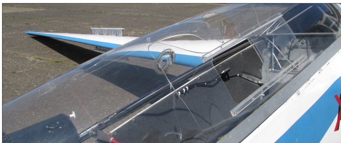
Rysunek 39. Uszkodzone oszklenie kabiny szybowca SZD-22 Mucha Std.
