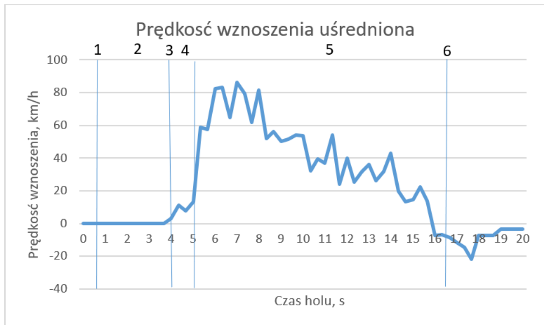
Rysunek 81. Wykres uśrednionej prędkości wznoszenia szybowca podczas holu. Źródło: załącznik 4.
