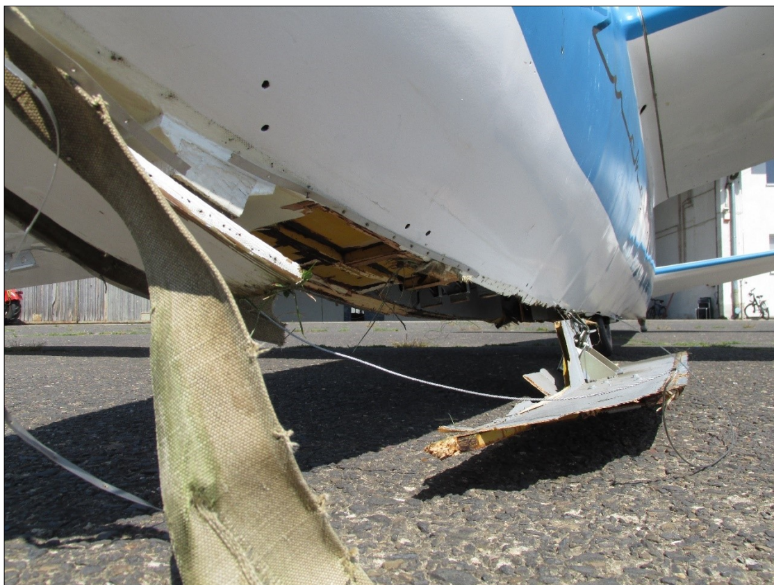
Rysunek 38. Wyrwana listwa kilowa wraz zaczepem SZD-22 Mucha Std. Źródło: M. Machnik.
