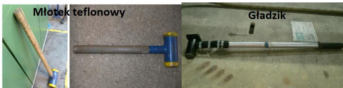
Rys. 28. Przykład młotków z teflonową końcówką oraz gładzika
