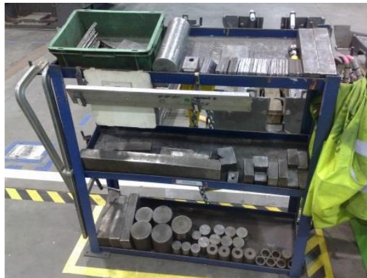
Rys. 29. Przykłady oprzyrządowania stosowanego podczas prostowania przy użyciu prasy
