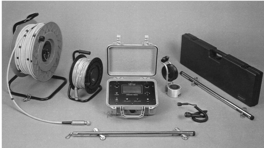
(Rys. 4.2.) Przykładowy zestaw urządzeń do prowadzenia pomiarów inklinometrycznych (Wolski i in., 2007)
