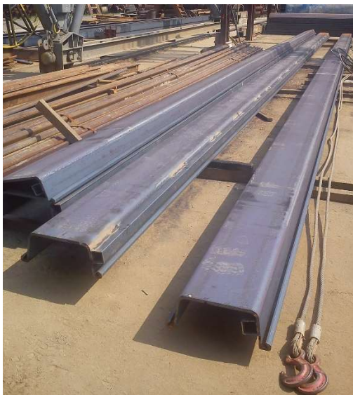
Rys 4.4. Grodziec stalowe z przyspawanymi profilami – przygotowane do wykonywania pomiarów przemieszczeń poziomych przy pomocy inklinometru
