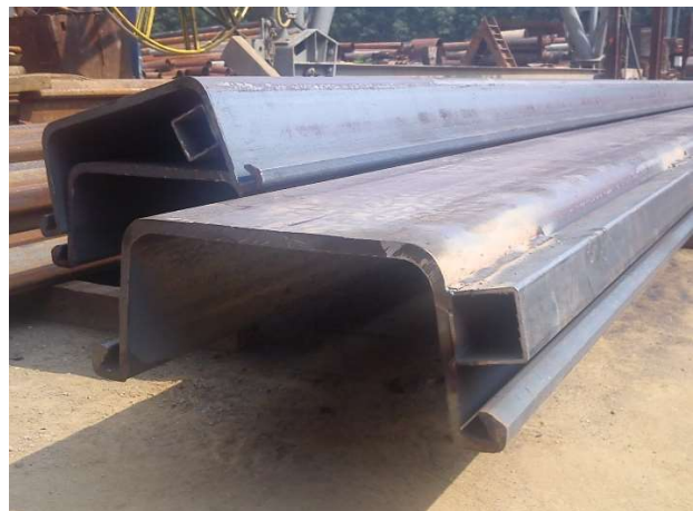
Rys 4.4. Grodziec stalowe z przyspawanymi profilami – przygotowane do wykonywania pomiarów przemieszczeń poziomych przy pomocy inklinometru
