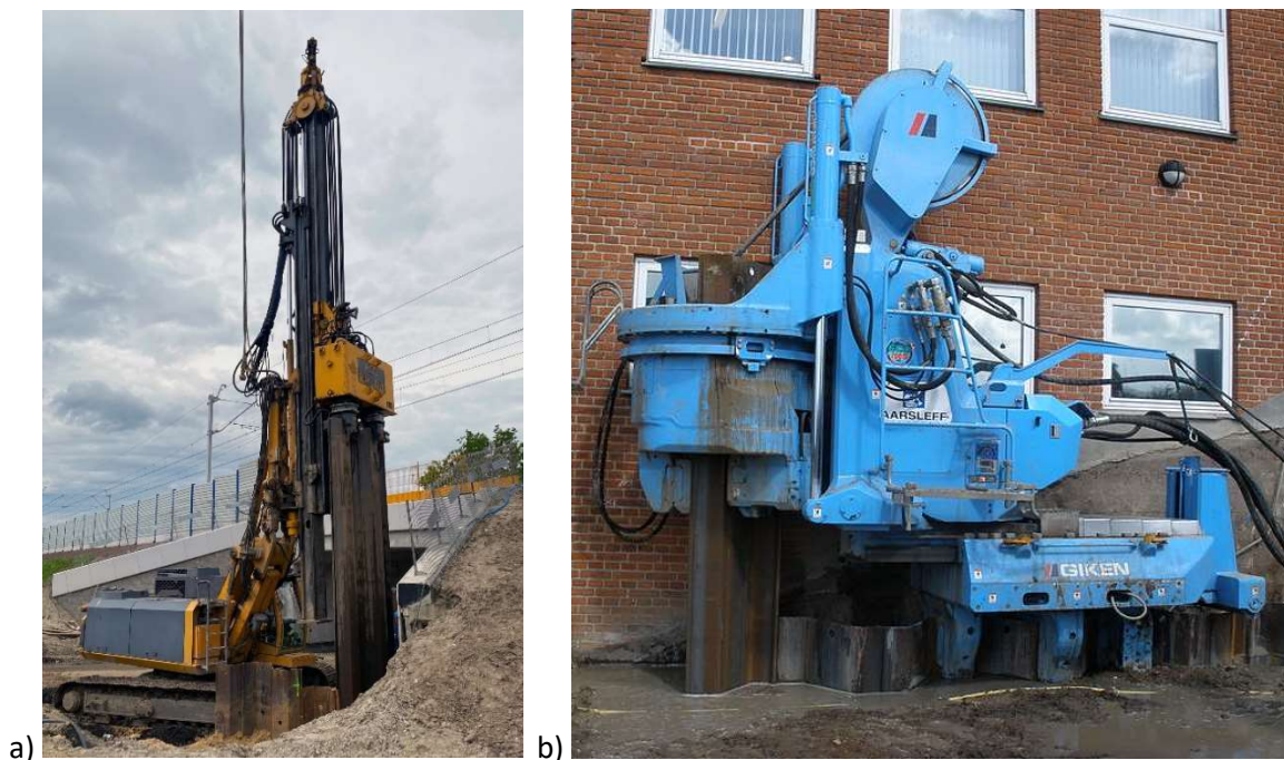
Rys. 1.3. Prasa hydrauliczna do wciskania grodzic stalowych: a) zamocowana na palownicy ( www.fedrecht.pl ); b) jednostka zamocowana na zagłębionych grodzicach ( https://commons.wikimedia.org/wiki/File:Silent_piler.jpg )
