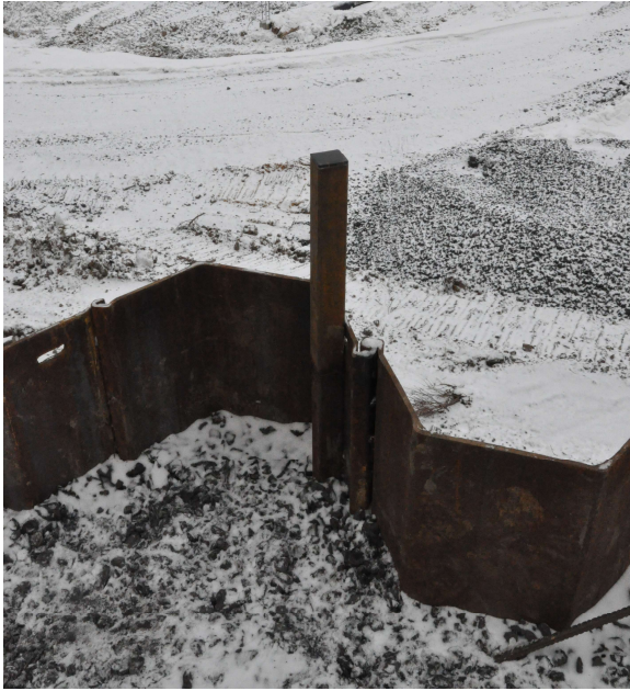
Rys. 4.9. Poletko badawcze nr 2 - Stanowisko dla pomiarów inklinometrycznych
