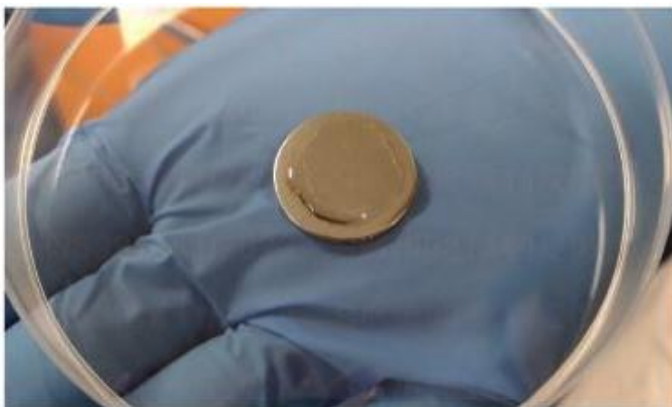
Rysunek 19. Dyski stalowe o średnicy d=2 cm, do badań nośnikowych bez udziału czynnika mechanicznego z naniesionym produktem do badania (EN 17387, 2021).
