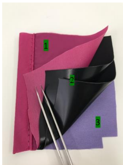
Rysunek 28. Zdjęcia fragmentu fartucha RTG z uwidocznionymi warstwami funkcjonalnymi 1,3 – poszycie tkaninowe; 2 – warstwy gumy ołowiowej
