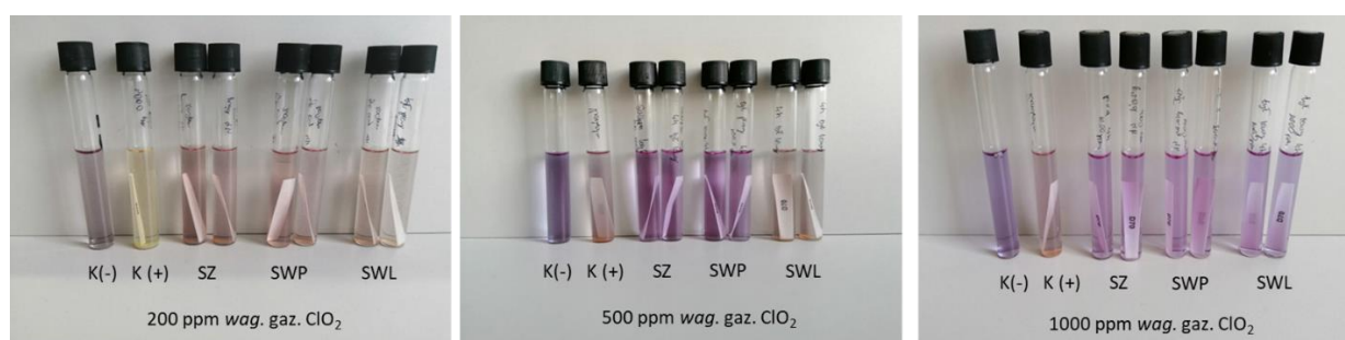
Rysunek 60. . Obserwacja zmiany barwy pożywki w procesie dezynfekcji fartuchów RTG dla stężeń 200 – 1000 ppm wag. ClO 2 . Oznaczenia: K(-) – kontrola ujemna, pożywka; K (+) – kontrola dodatnia, wskaźnik nie poddany ekspozycji ClO 2 ; SZ – wskaźniki umieszczone na z zewnętrznej stronie fartucha; SWP – wskaźniki umieszczone na wewnętrznej prawej stronie fartucha; SWL – wskaźniki umieszczone na wewnętrznej lewej stronie fartucha.
