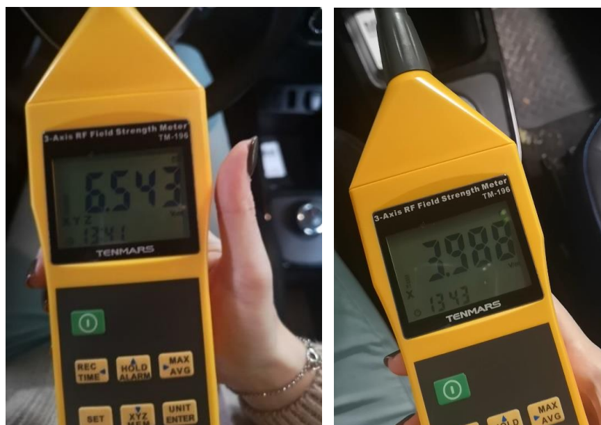
Rys. 85. Przykładowe wyniki pomiarów pola elektromagnetycznego wewnątrz pojazdów [opracowanie własne]
