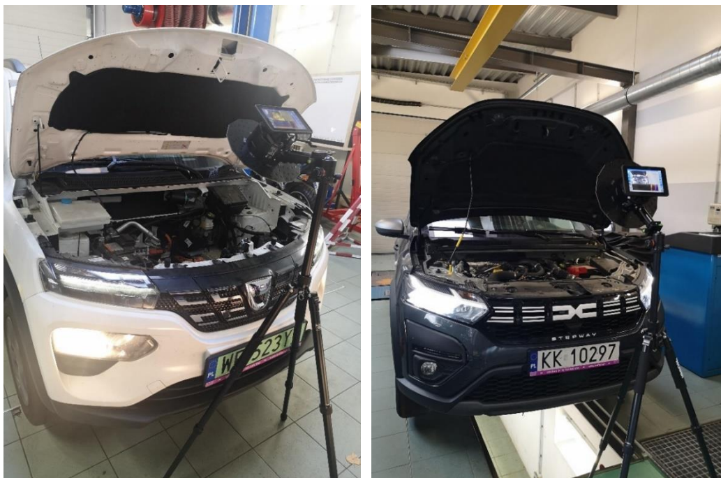
Rys. 22. Ustawienie kamery akustycznej podczas pomiaru poziomu natężenia dźwięku w badanych pojazdach [opracowanie własne]
