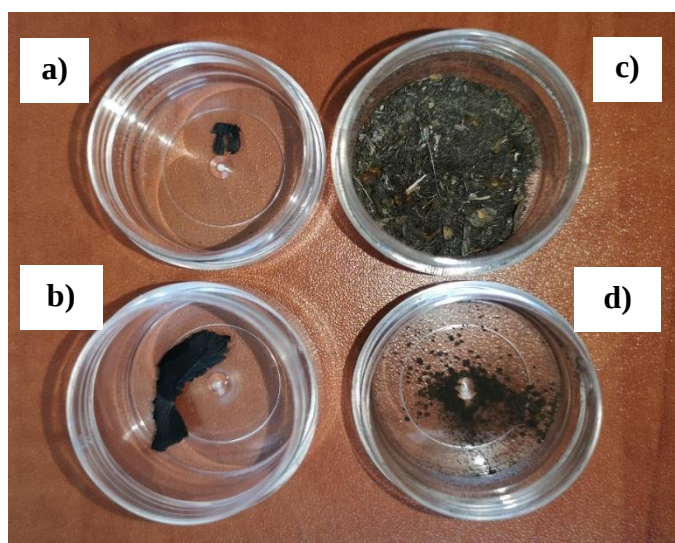
Rys. 113. Próbki pyłu – a), b) próbka opony samochodu osobowego, c) próbka pyłu zebrana z filtra powietrza, d) próbka pyłu z układu hamulcowego [opracowanie własne]
