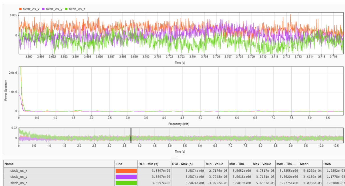
Rys. 62. Przebieg czasowy wraz z charakterystyką częstotliwościową przyspieszenia drgań samochodu z napędem hybrydowym przenoszonych na kierowcę (drgania ogólne) podczas badań na stanowisku – uruchomiony napęd spalinowy [opracowanie własne]
