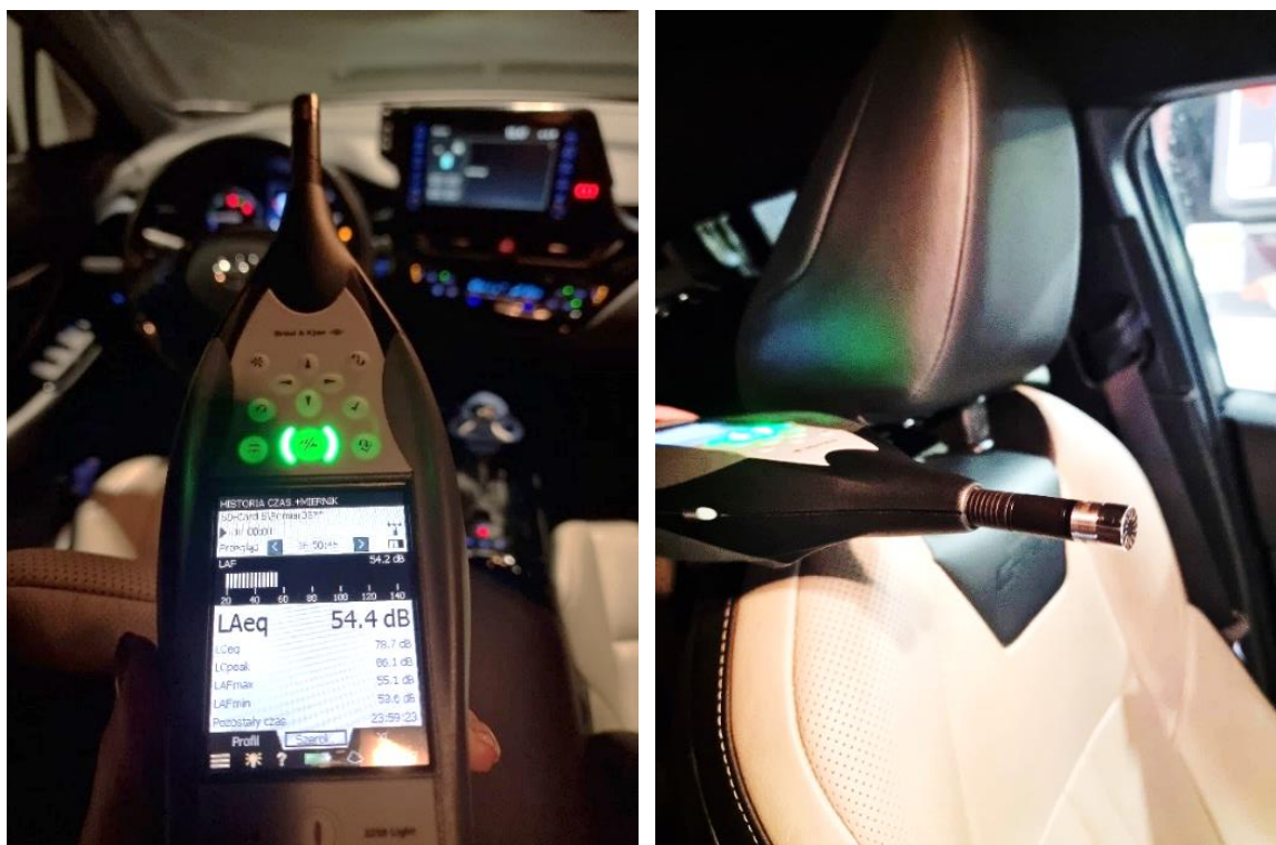
Rys. 33. Pomiary hałasu wewnętrznego – po lewej stronie urządzenie pomiarowe, po prawej stronie umiejscowienie miernika [opracowanie własne]
