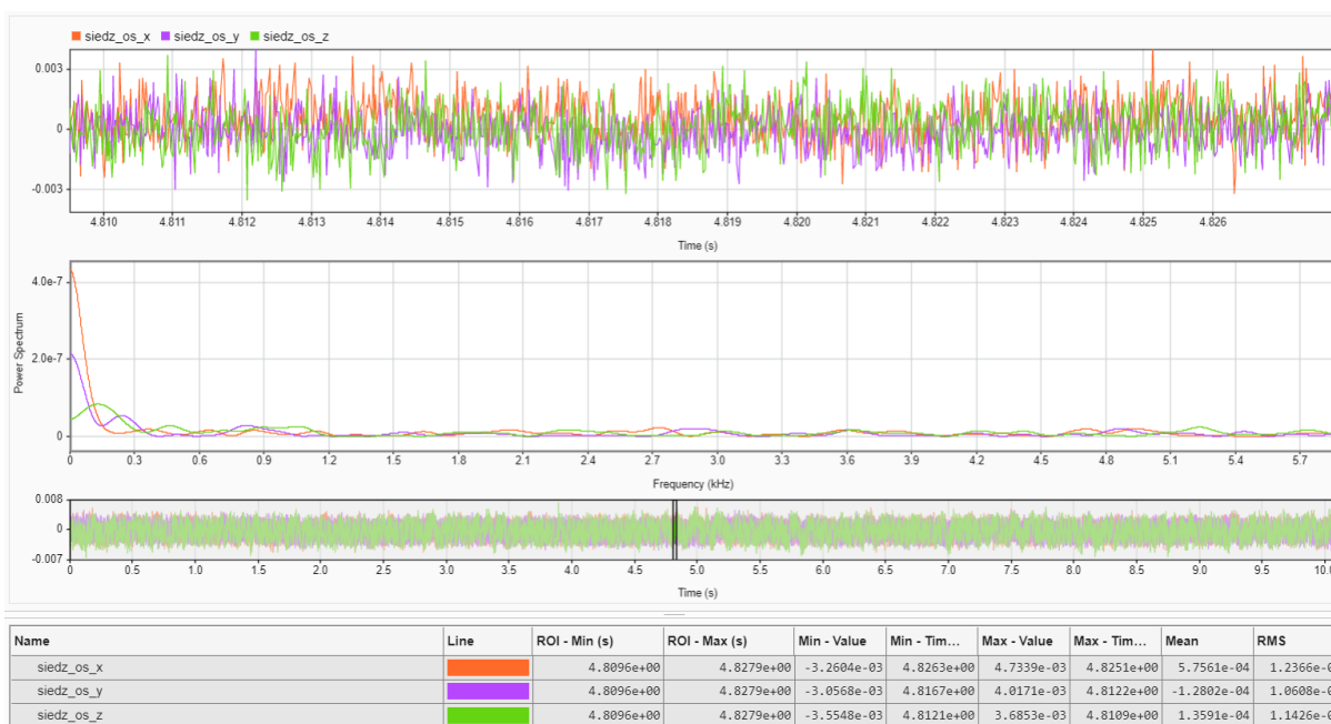
Rys. 60. Przebieg czasowy wraz z charakterystyką częstotliwościową przyspieszenia drgań samochodu z napędem elektrycznym przenoszonych na kierowcę (drgania ogólne) podczas badań na stanowisku [opracowanie własne]
