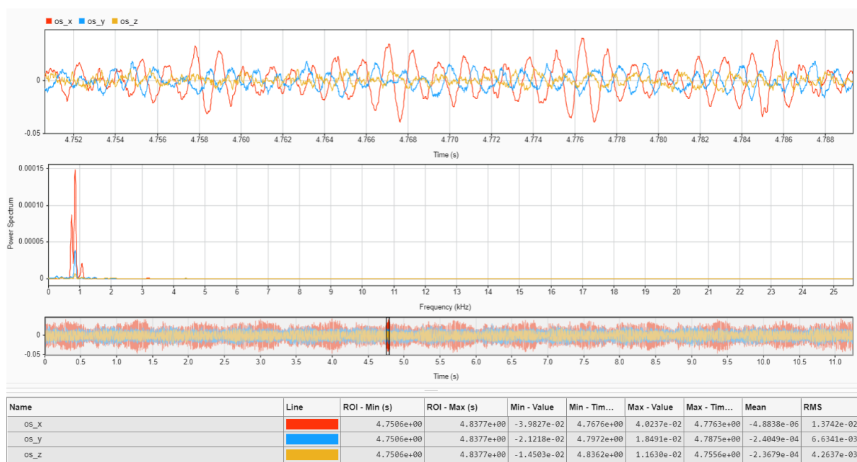
Rys. 55. Przebieg czasowy wraz z charakterystyką częstotliwościową przyspieszenia drgań nadwozia samochodu z napędem elektrycznym podczas badań na stanowisku [opracowanie własne]
