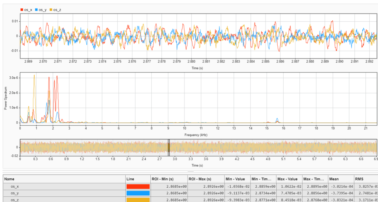
Rys. 57. Przebieg czasowy wraz z charakterystyką częstotliwościową przyspieszenia drgań nadwozia samochodu z napędem hybrydowym nadwoziu podczas badań na stanowisku – uruchomiony napęd spalinowy [opracowanie własne]
