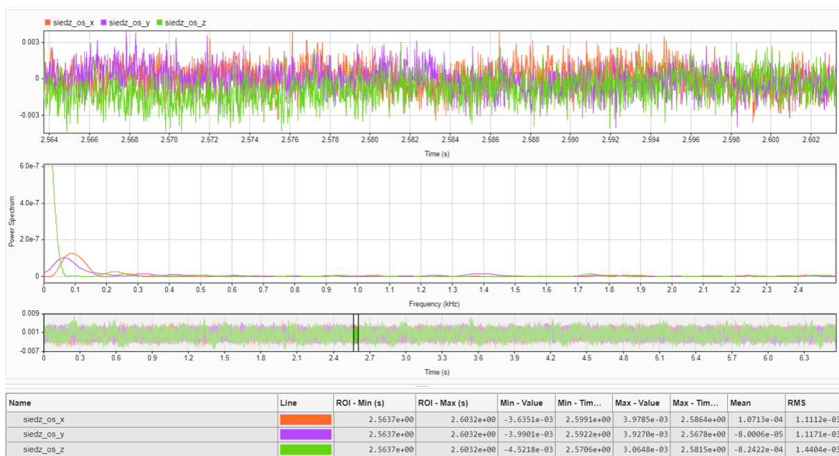
Rys. 61. Przebieg czasowy wraz z charakterystyką częstotliwościową przyspieszenia drgań samochodu z napędem hybrydowym przenoszonych na kierowcę (drgania ogólne) podczas badań na stanowisku – uruchomiony napęd elektryczny [opracowanie własne]
