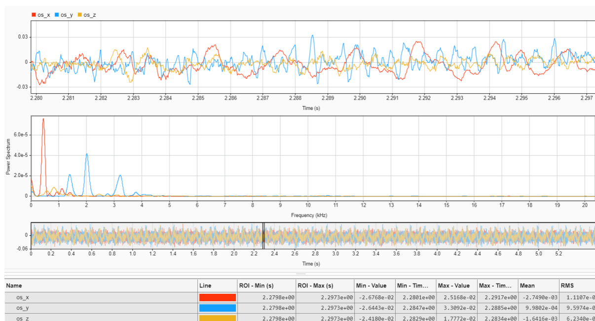
Rys. 54. Przebieg czasowy wraz z charakterystyką częstotliwościową przyspieszenia drgań nadwozia samochodu z napędem konwencjonalnym podczas badań na stanowisku [opracowanie własne]
