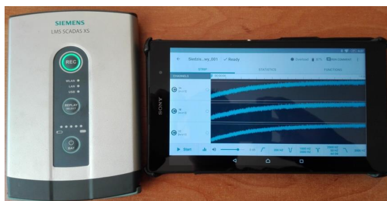
Rys. 51. Układ pomiaru drgań Siemens LMS SCADAS XS z urządzeniem akwizycji danych [opracowanie własne]
