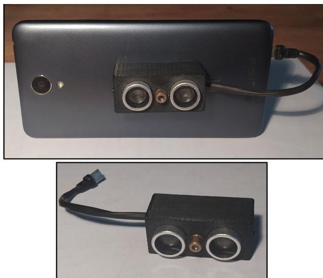
Rys. 49: Urządzenie pomiarowe wraz ze sposobem połączenia ze smartfonem
