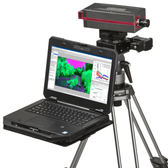
Rys. 7: Kamera hiperspektralna na statywie [244]
