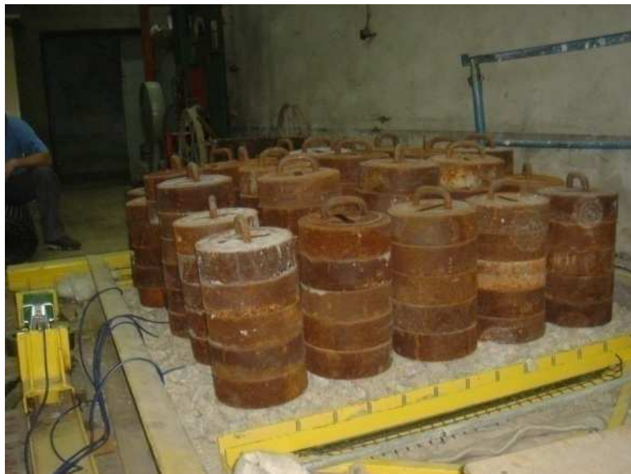
Rys. 3.17. Badanie charakterystyki georusztu zabudowanego w kruszywo, widok na stanowisko podczas badania.
