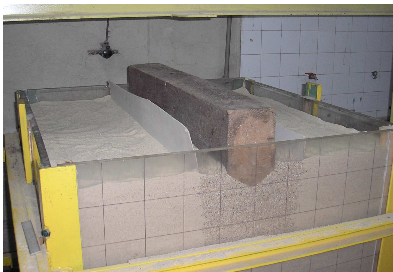
Rys. 5.10. Zdjęcie etapu budowy modelu 7. Widoczne pasy tektury ograniczającej przestrzeń przy formowaniu poduszki, ułożony model fundamentu przed obciążeniem.
