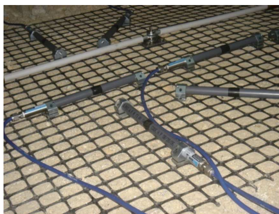
Rys. 3.15. Schemat stanowiska (zaprojektowanego i wykonanego przez autora dysertacji) do badania współpracy szerokich próbek geosyntetyku z wypełnieniem. a) — stanowisko przed obciążeniem; b) — stanowisko po obciążeniu. Źródło: Kawalec J. [54].
