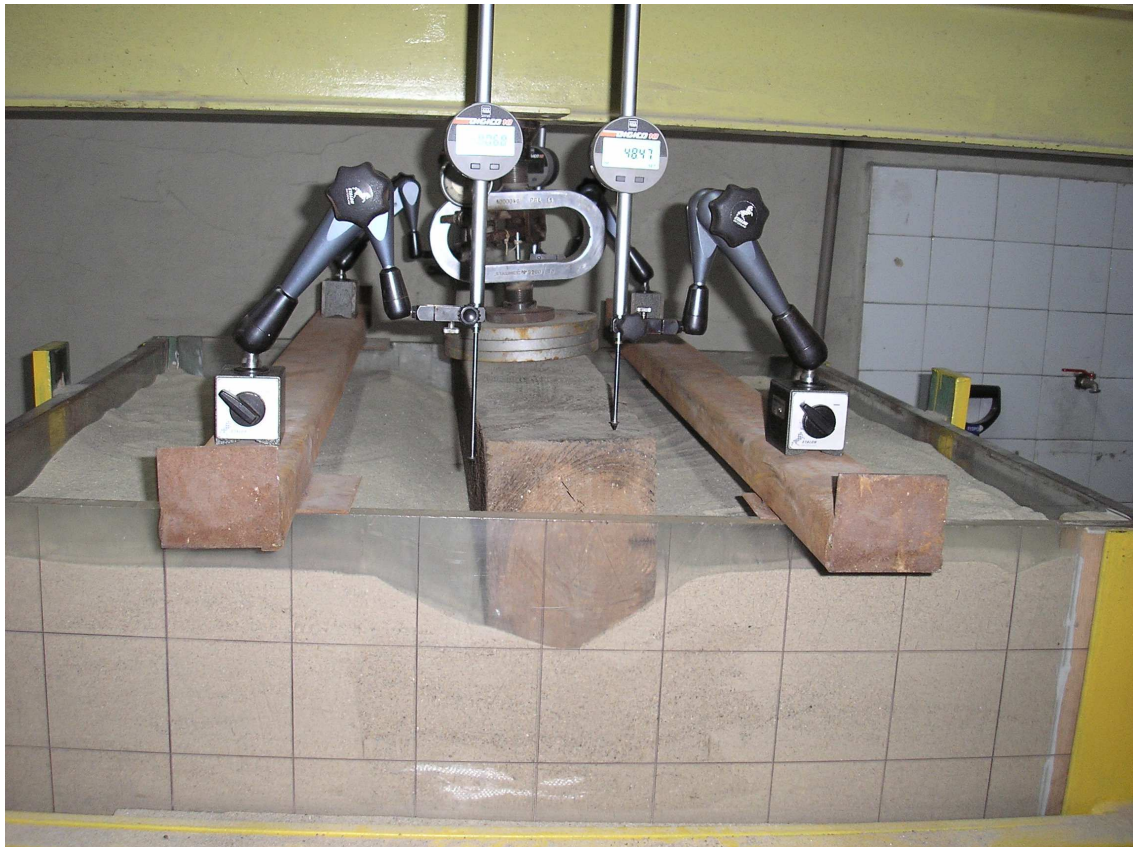
Rys. 5.12. Widok na model fundamentu z wzmocnieniem matercem z geotkaniny owiniętej wokół kruszywa (model 8) po zniszczeniu. Widoczne przemieszczenia fundamentu oraz brak wyparcia materiału spod materaca (ścięcie nastąpiło w materiale poduszki).
