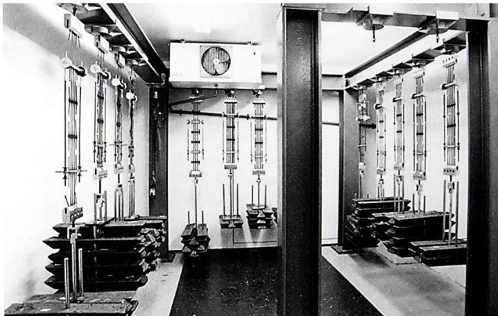
Rys. 3.8. Stanowisko do badania pelzania geosyntetyków. Laboratorium Tensar International Limited. Źródło: [117].
